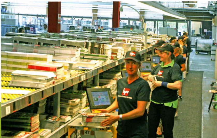
Die Mitarbeiter sind stolz auf die neue HS News Anlage und posieren für das Foto in bpv-Shirts: 120 Titel in bis zu acht Packzonen lassen sich auf der halbautomatischen Anlage kommissionieren
